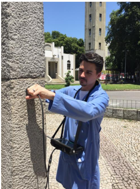
Figura 50. Medição de velocidade ultrassônica em um dos portais do Monumento de Noel Rosa
