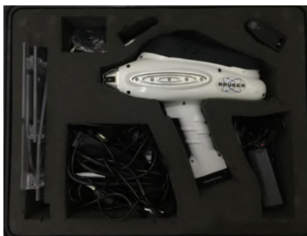
Figura 45: FRX portátil da marca Bruker utilizado na aquisição de dados em campo
