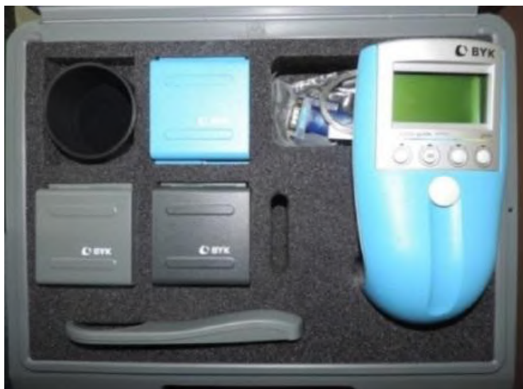
Figura 47. Aparelho portátil Spectro-Guide Sphere Gloss utilizado em campo. Fonte: Ricardo (2015)
