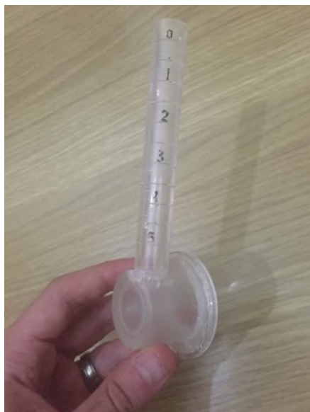
Figura51. Tubo de Karsten utilizado em campo
