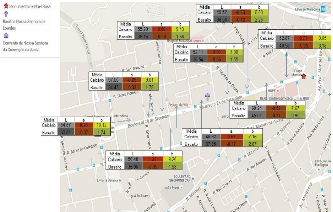
Figura 83. Valores médios de cor nos quarteirões norte da Boulevard 28 de Setembro das rochas da calçada musical e do gnaisse facoidal do meio-fio. Adaptado do Google Maps
