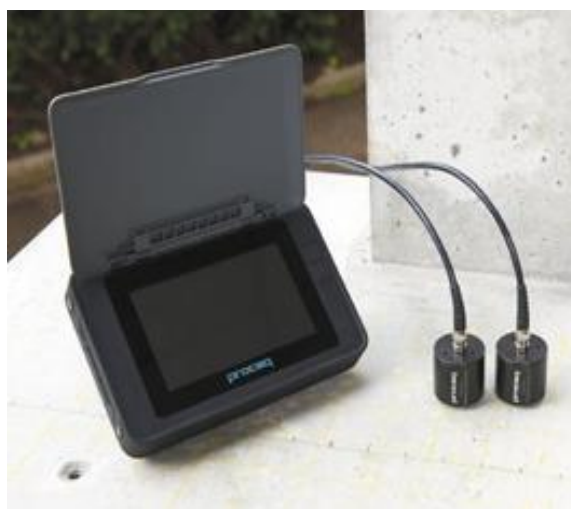
Figura49. Portable Ultrasonic Non Destructive Indicator Tester (PUNDIT)
