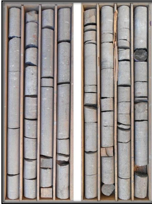
Figura 1.1 - Fotografia das caixas contendo os testemunhos de sondagem do poço 1UN-26. Caixas 16 e 17, de profundidades 68,15-72,15m e 72,15-76,15m respectivamente.
