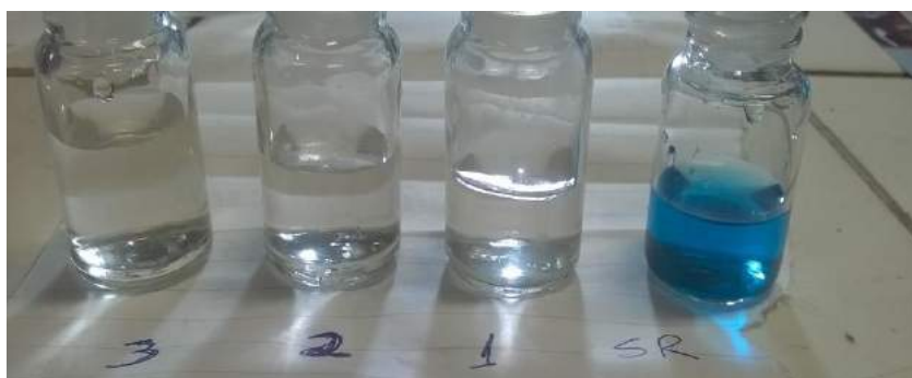
Figura 19: Experimento de regeneração do compósito por reação foto-fenton, onde: SR – alíquota de sobrenadante da solução de AM após adsorção do compósito e que não sofreu fotocatalise; 1, 2 e 3 – Alíquotas do sobrenadante da solução de AM após adsorção do compósito ; 1, 2 e 3 são os ciclos de adsorção do compósito regenerado
