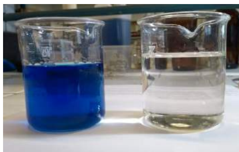
Figura 16: Teste de adsorção da solução 60 mg/L de AM AM com (direita) e sem (esquerda) a adição do compósito
