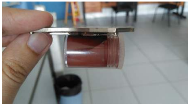
Figura 12: Fe 2 O 3 calcinado a 300°C apresentando elevada magnetização na presença do ímã de disco rígido composto de Nd
