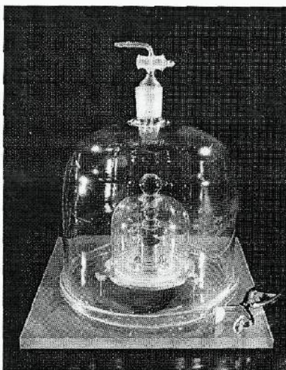
O protótipo internacional do quilograma, K, o único padrão materializado, ainda em uso, para definir uma unidade de base do SI.
