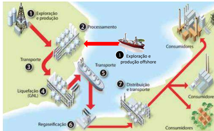
Figura 4 - A cadeia produtiva do gás natural - Fonte: Adaptador pelo autor com base em (ANP, 2010)
