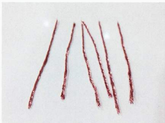
Figura 29 – Fios condutores desencapados e enrolados (Passo 2).
