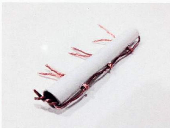
Figura 31 – Fio rígido contornando ferro por dentro e por fora, preso na ponta (Passo 4).
