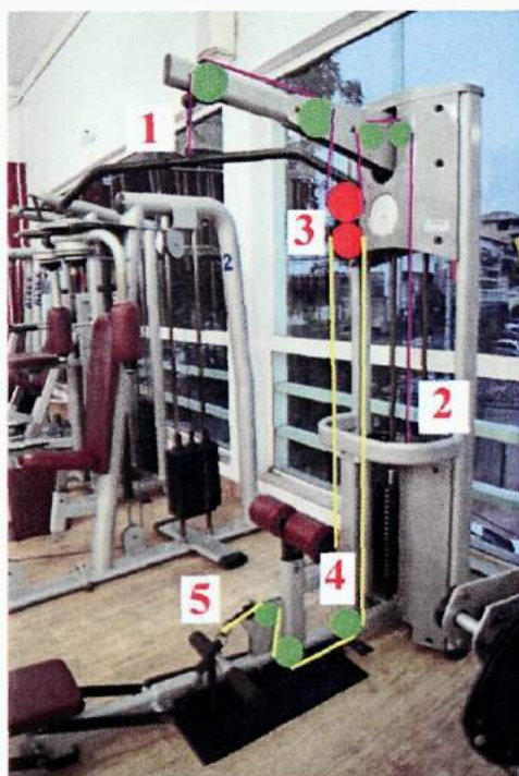
Figura 46 – Esquema de cabeamento do aparelho com polia inferior.
