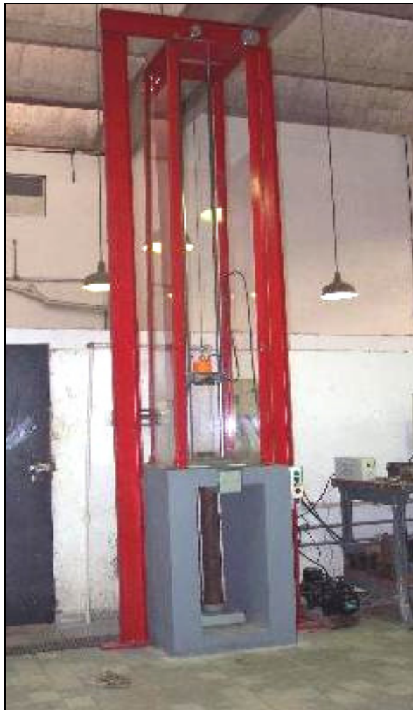
Figura 3.5 – Célula de Carga de Impacto de 100 mm (LTM/COPPE/POLI/UFRJ)
