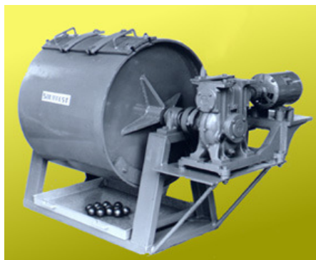
Figura 3.6 – Moinho padronizado para o ensaio de Abrasão Los Angeles
