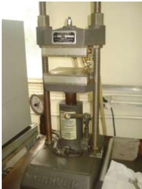
**Figura 13:** Prensa hidráulica modelo # 3912 da CARVER.
