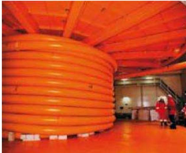
**Figura 5:** PVDF utilizado em dutos para sistemas offshore [10].
