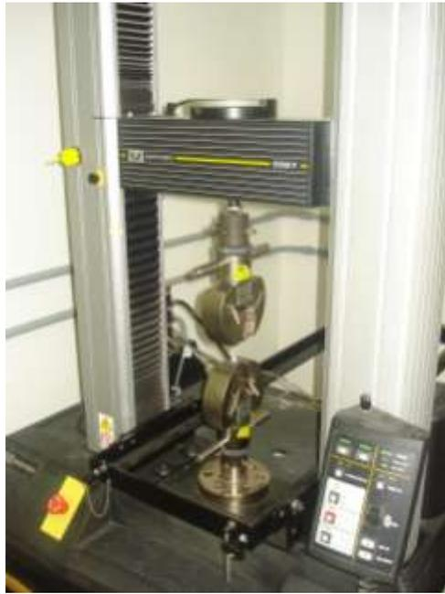
**Figura 15:** Máquina de tração modelo INSTRON 5567.
