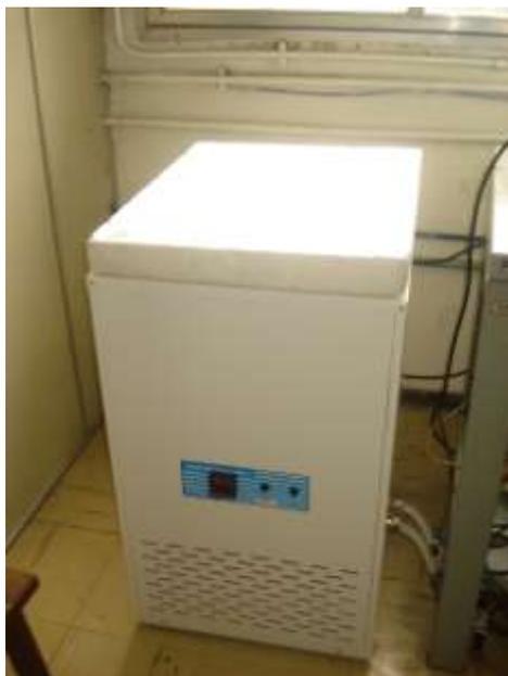
**Figura 14:** Banho ultratermostático da M.S.MISTURA modelo – MSM 200/22.
