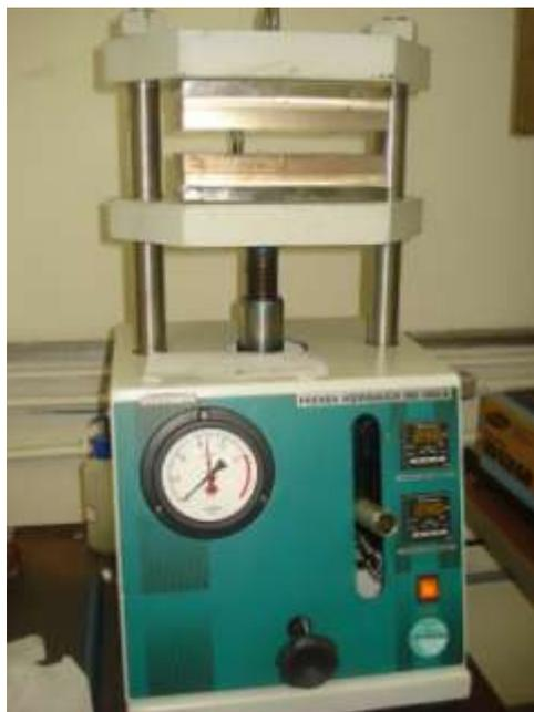
**Figura 12:** Prensa hidráulica MARCONI modelo MA 098/A.
