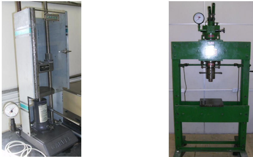
Figura 3.6- As prensas axiais: para pastilhas (Carver) e para placas (EVA).
