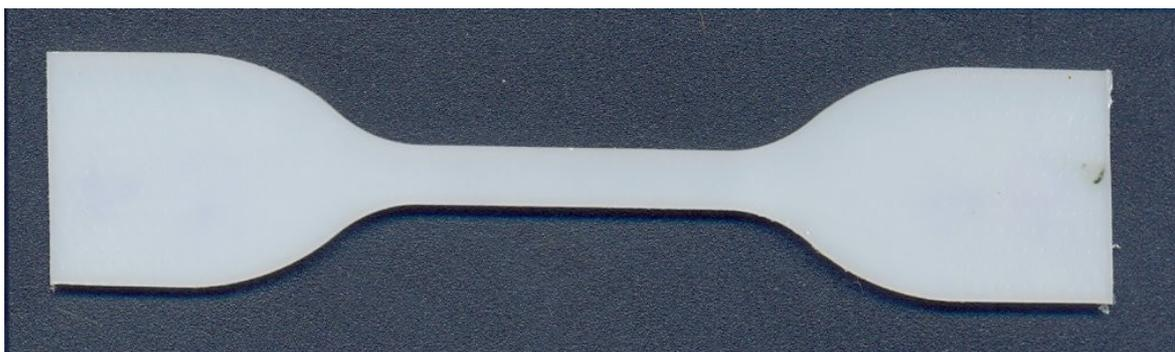
**Figura 3:** Corpo de prova de tração feito de PVDF utilizado neste trabalho.
