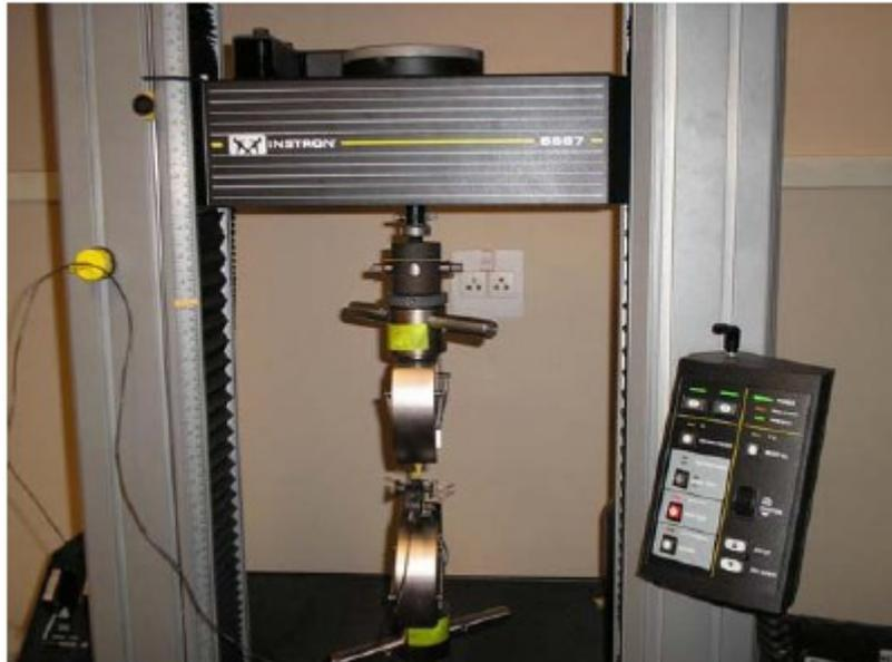
**Figura 4:** Máquina Instron para de tração.
