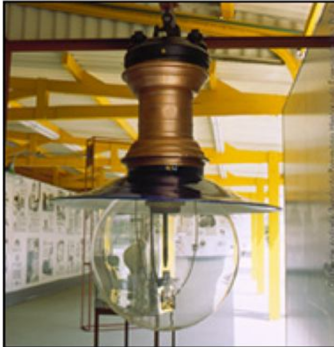
Figura 2 - Lâmpada de arco voltaico, tipo arco fechado utilizada em São Paulo 1905 e 1920 – Museu da Energia [2]
