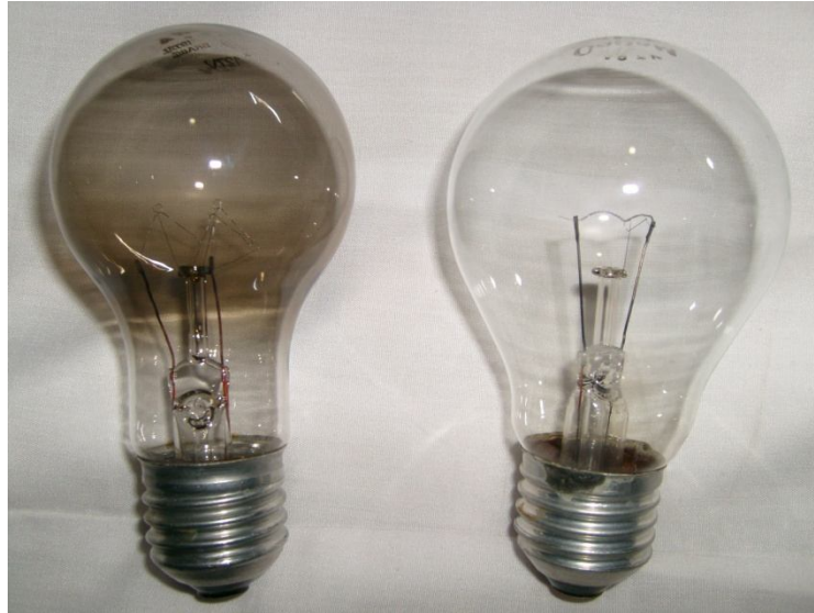
Figura 10 – Depreciação do fluxo luminoso.
