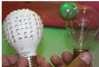
Figura 31 – Luminária LED de 30 W, substituta da lâmpada incandescente de 150 W.
