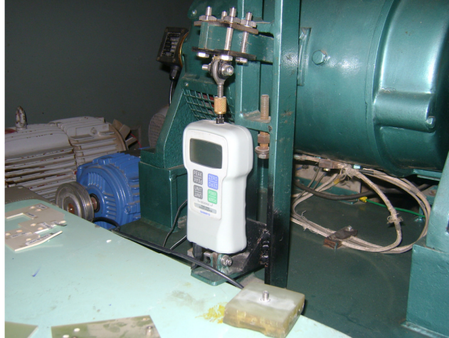
Figura 13: Célula de carga no lugar da balança, com o conhecimento da distância do braço de força, é possível determinar o torque.
