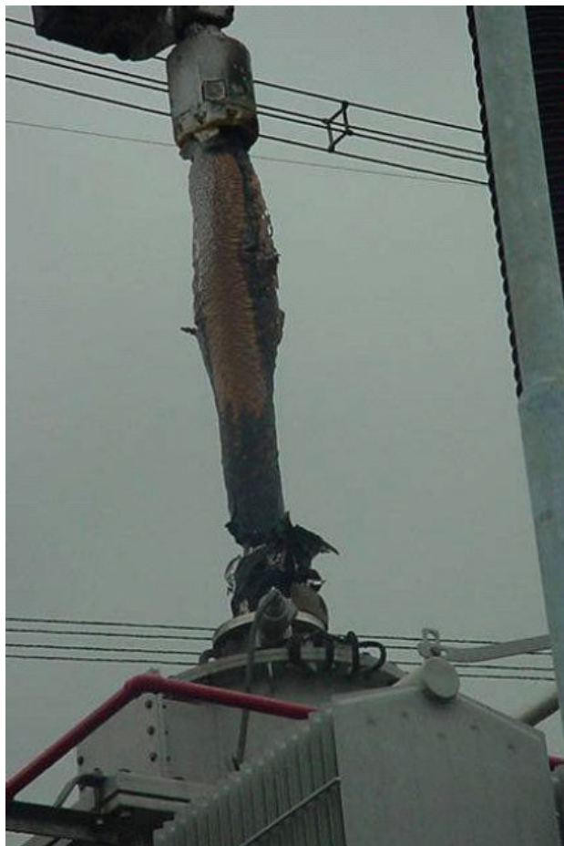
Figura 1 - Bucha de alta tensão após ocorrência de falha. Fonte: Monitoramento e Diagnóstico de Buchas de Alta Tensão [9].
