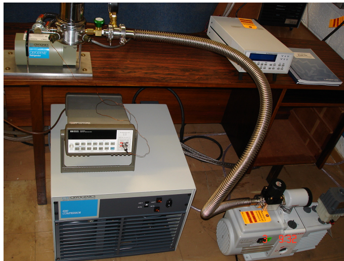
Figura 2.3: Sistema para levantamento da curva R \times T – Laboratório de Supercondutividade do CEPTEL.
