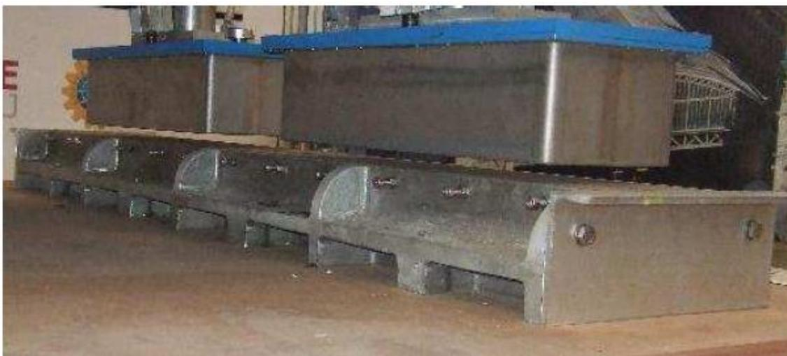
Figura 2 – Levitação Supercondutora no LASUP
