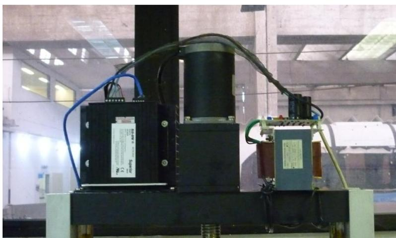
Figura 13 – Motor de passo linear
