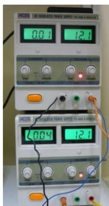
Figura 12 – Foto da fonte de tensão regulada ligada em série ICEL, modelo PS-4000
