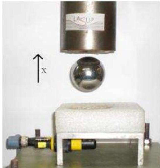
Figura 3 – Experiência de Levitação Eletromagnética desenvolvido no LASUP
