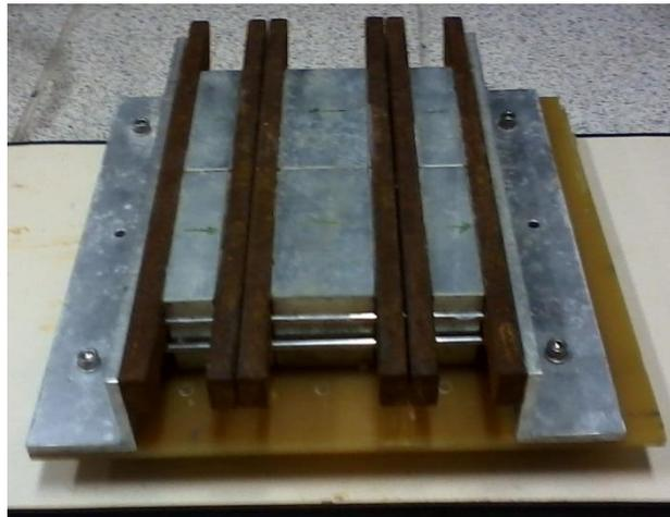
Figura 17 – Protótipo do trilho magnético ¼ de Hallbach montado para os ensaios da força de levitação magnética
