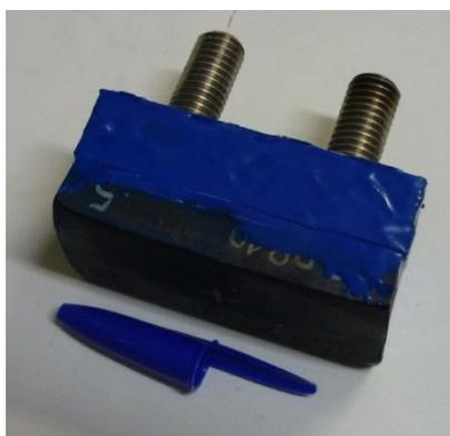
Figura 15 – Foto do bloco supercondutor, comparando-o a uma tampa de caneta “BIC”
