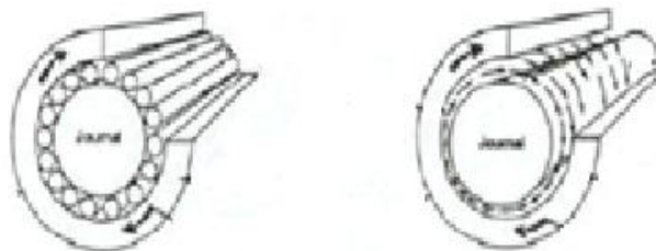
Figura 2. 6: Esquema Básico de Rolamentos de Cilindros e Cilindros de Fricção (Adaptado: PLÁCIDO, J., PINHO, R., 2009)
