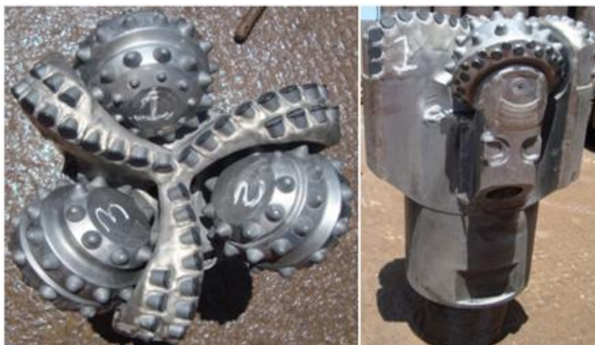
Figura 4. 9: Broca Híbrida Após a Corrida (Fonte: THONSON, I., KRASUK, R., ROMERO, K., 2011)
