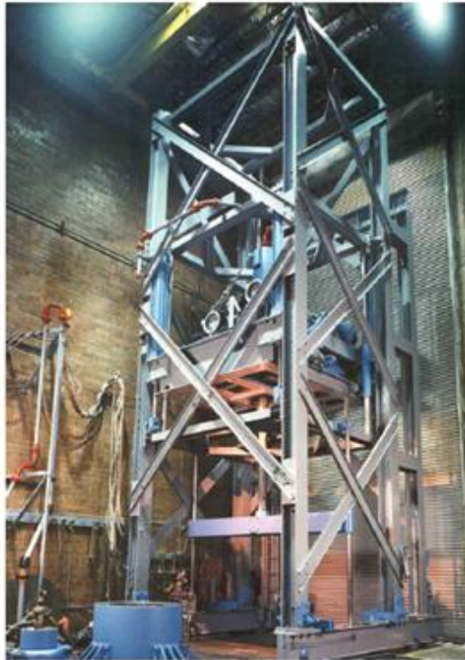
Figura 3. 2: Simulador de Sonda de Perfuração da TerraTek (Fonte: JUDZIS, A., BLAND, R., CURRY, D., BLACK, 2009)
