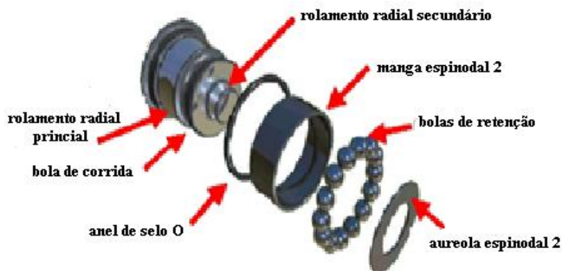
Figura 2. 10: Esquema de um Conjunto de Selo-Rolamento de Fricção (Adaptado: PLÁCIDO, J., PINHO, R., 2009)
