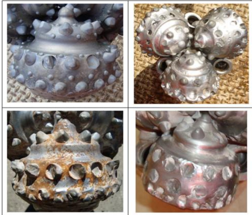
Figura 4. 3: Brocas Tricônicas Danificadas (Fonte: THONSON, I., KRASUK, R., ROMERO, K., 2011)
