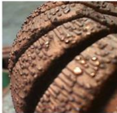
Figura 2. 19: Broca Impregnada Desgastada (Fonte: PLÁCIDO, J., PINHO, R., 2009)
