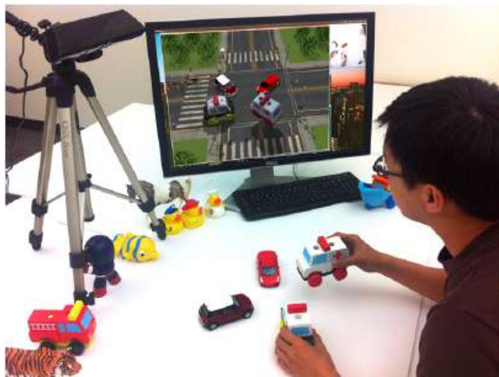
Figura 2.19: A configuração do sistema permite utilizar brinquedos e outros objetos físicos rígidos para realizar uma animação 3D. Figura retirada de [47].
