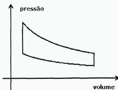
Figura 14 - Ciclo composto por duas isotérmicas e duas isocóricas.
