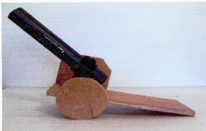
Figura 6 – Canhão construído para estudar o lançamento oblíquo.
