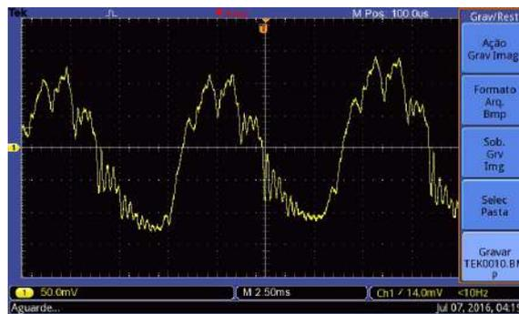
Figura 5.20: Leitura da resposta do sensor com o rotor sem defeitos no osciloscópio com o sensor no furo 1 a 80% de carga. Eixo vertical: 50 mV/div; Eixo horizontal: 2,50 ms.
