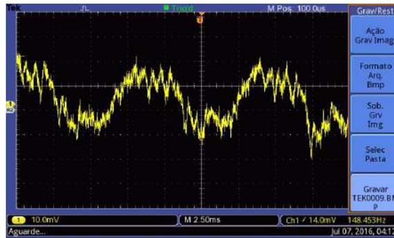
Figura 5.18: Leitura da resposta do sensor com o rotor sem defeitos no osciloscópio com o sensor no furo 3 a 80% de carga. Eixo vertical: 10 mV/div; Eixo horizontal: 2,50 ms.
