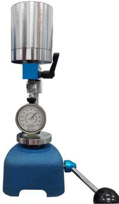
Figura 4.11: Durômetro Shore-D utilizado em corpos de prova do epóxi utilizado nos sensores. Cedido por Pita, Victor, IMA/UFRJ.
