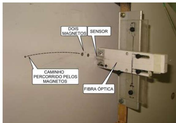
Figura 4.20: Sensor montado em uma janela de observação da proteção do disco.
