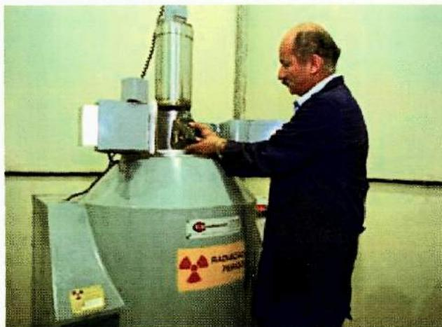
*Figura 15: Entre outras funções, a câmara de radiação do Ipen é utilizada para esterilizar produtos.*
