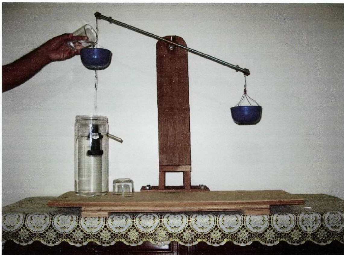
FIGURA 17 – Reposição do líquido deslocado na balança.
