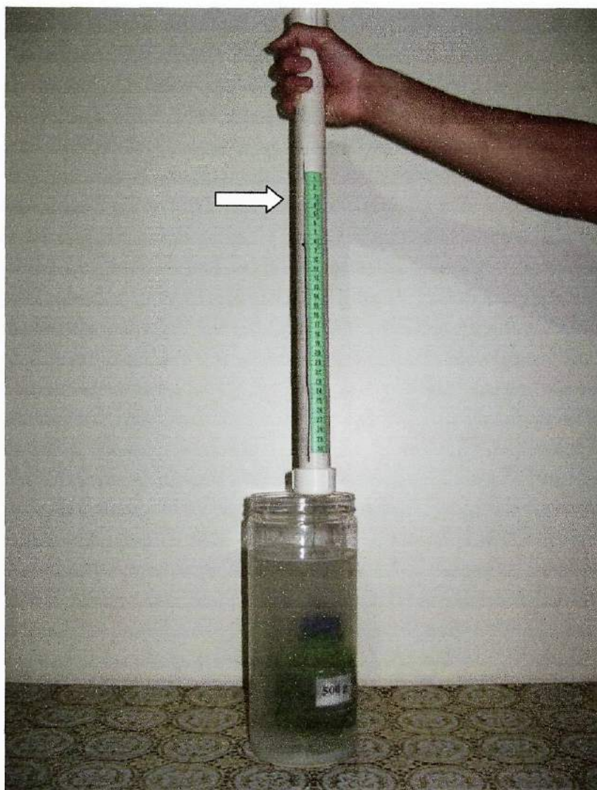
FIGURA 11 – Situação 3: pesagem do corpo mergulhado na salmoura.
