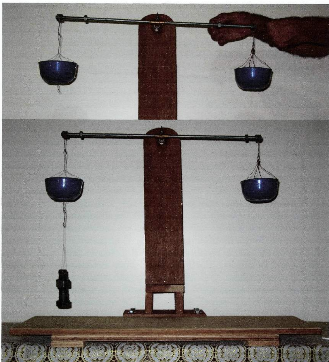
FIGURA 13 – Ajuste do equilíbrio da balança.
