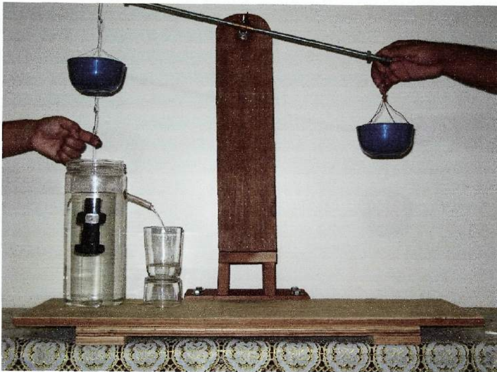
FIGURA 15 – Recolhimento do volume de líquido deslocado.
