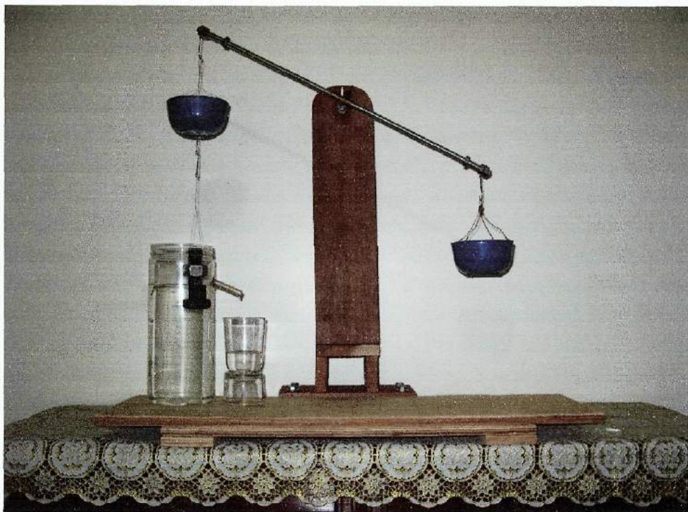
FIGURA 16 – Observação do desequilíbrio provocado na balança devido ao empuxo sobre o corpo mergulhado.
