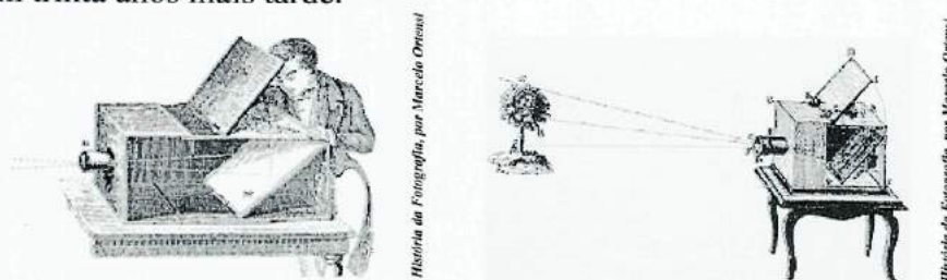
Figura 6.12: Câmara escura compacta, com um espelho, e seu esquema básico de funcionamento.
