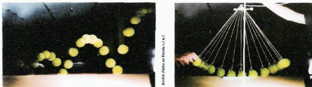
Figura 4.5: Fotografias estroboscópicas uma bola de tênis pingando e oscilando em um pêndulo
