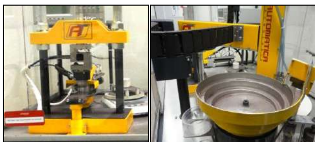
Figura III.19 Equipamento de testes de Resistência à Compressão das pelotas.
