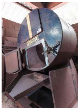
Figura III.20 Tambor de abrasão onde é avaliado o Índice de Tamboramento das pelotas queimadas.
