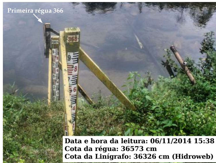
Figura 6.21: Foto da leitura da régua (Est. 58350001) na estação 2 no dia 06/11/2014 as 15:38 e comparação com o dado disponibilizado pela Hidroweb para mesmo dia e hora
