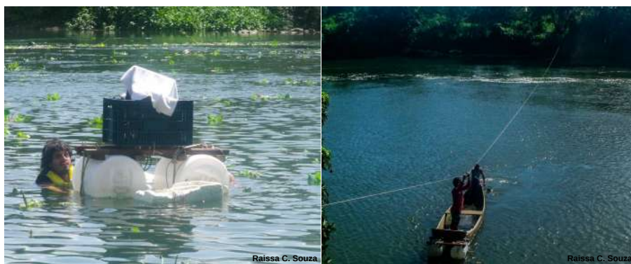
Figura 4.24: Campanhas de medição de vazão com ADCP. Medição utilizando apenas a balsa Papillon (foto à esquerda) e medição utilizando uma canoa apoiando a balsa Papillon (foto à direita).
