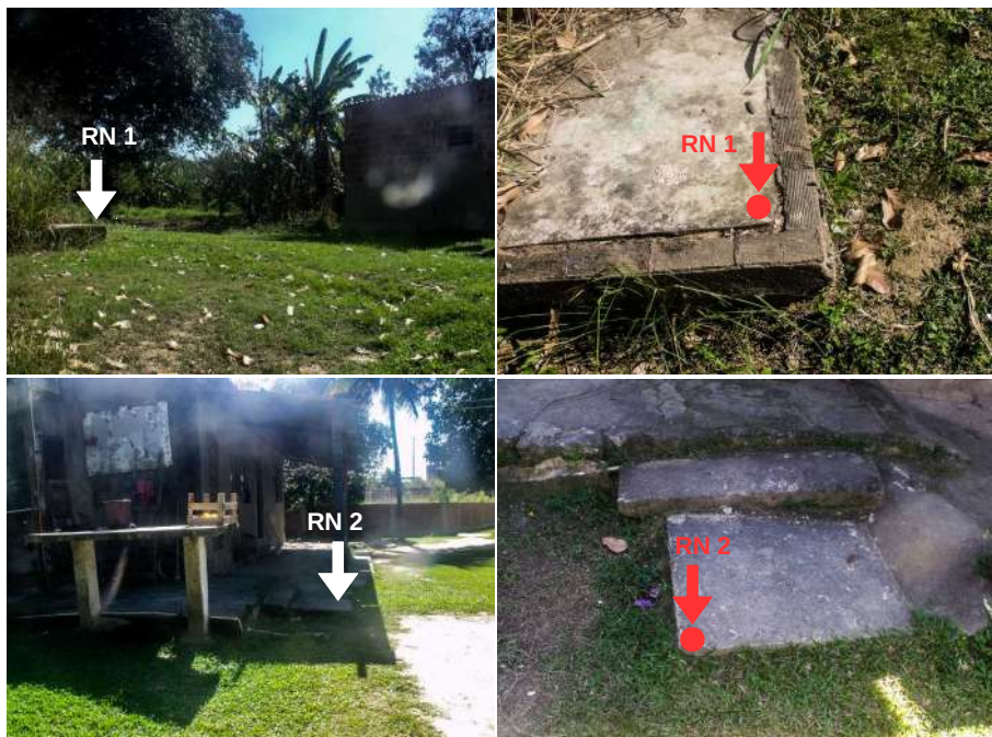
Figura 4.16: Descrição dos pontos definidos como níveis de referência ba estação 9, a jusante da ETA-Guandu.
