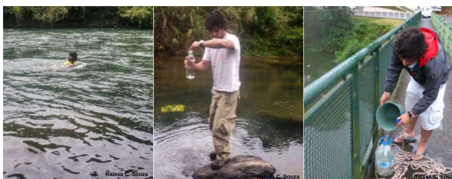
Figura 4.3: Formas de coleta das amostras de água. Coleta no meio do rio com ajuda de nadadeiras e colete salva-vidas (foto a esquerda), rio Guandu - estação 6. Coleta direta no meio do rio pelas pedras (foto do centro), rio Piraí - estação 2. Coleta no meio do canal com balde e corda pela ponte (foto a direita), tomada do UEL Vigário - estação 3.
