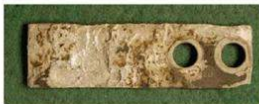
Figura 10: Cupom de aço L80 13Cr exposto à água produzida Fonte: (36)
