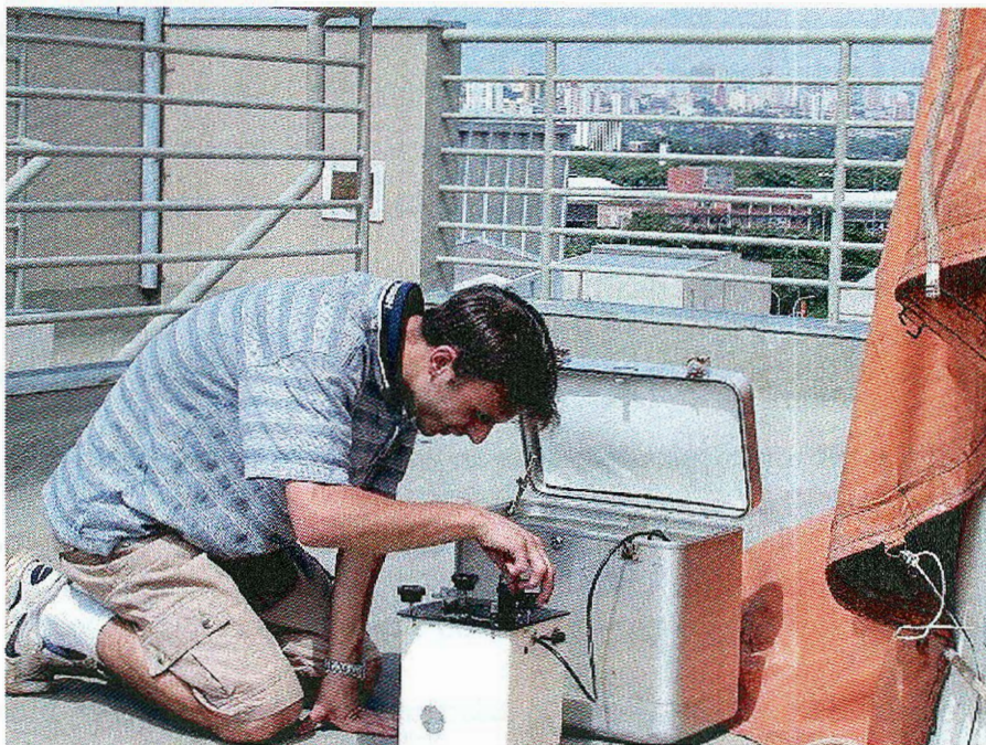
Figura 25 - Foto mostrando uma tomada de dado com um gravímetro LaCost Romberg (IAG-USP). Note que o aparelho é conectado a uma bateria que o mantém a uma temperatura de \sim 40^{\circ}\text{C} .
