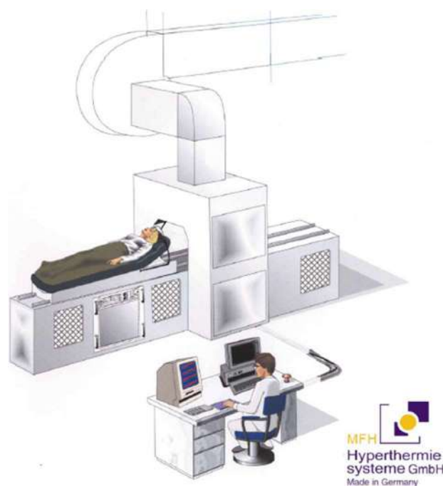
Figura 7 - Esquema do primeiro protótipo para testes clínicos de hipertermia magnética (MFH Hyperthermie systeme GmbH, Berlin, Germany). Adaptado de (JORDAN et al., 2001).
