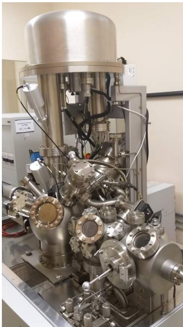
Figura 25: Espectrômetro ESCALAB 250Xi do Laboratório Multiusuário de Espectroscopia de Fotoelétron utilizado para análise XPS.
