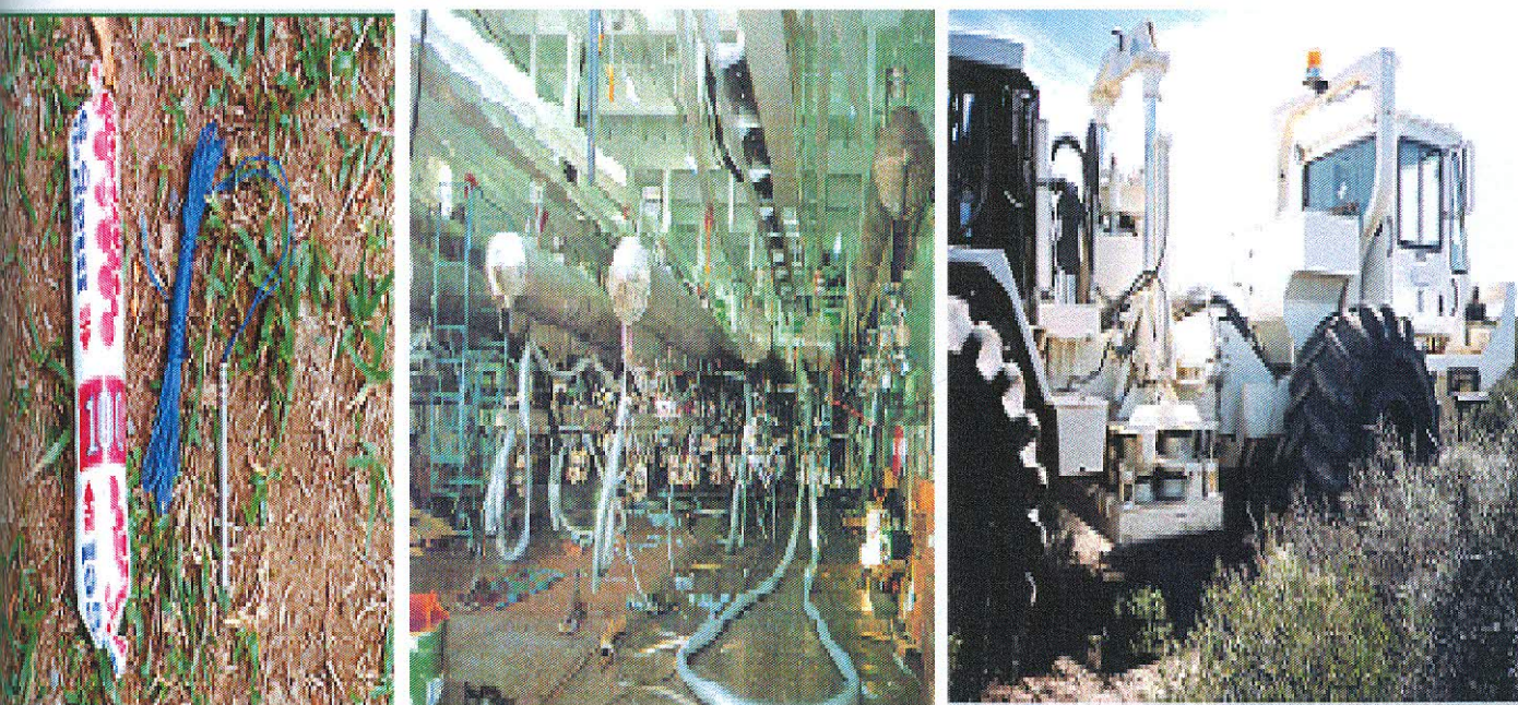
Figura 35 – Diferentes tipos de fonte sísmica: dinamite (aquisição terrestre), air-gun (aquisição marítima) e vibrador (Chaves, 2006).
