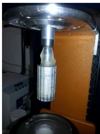
Figura 4.9: Geometria do ensaio reológico após o deslizamento do hidrogel para a parte superior da haste por conta da viscosidade elevada.
