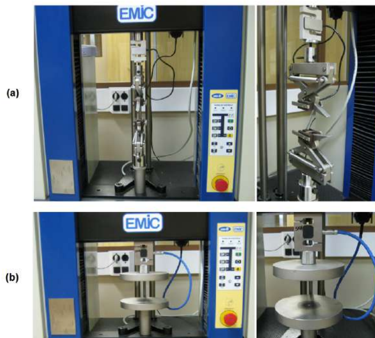
Figura 3.7: Máquina de ensaio EMIC usada no teste de (a) tração e (b) compressão.
