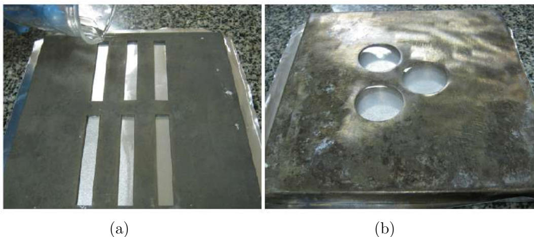
Figura 3.5: Placa molde usada para a confecção dos corpos de prova para os testes de (a) tração e (b) compressão.
