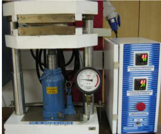
Figura 3.6: Prensa utilizada para realizar a moldagem dos corpos de prova.
