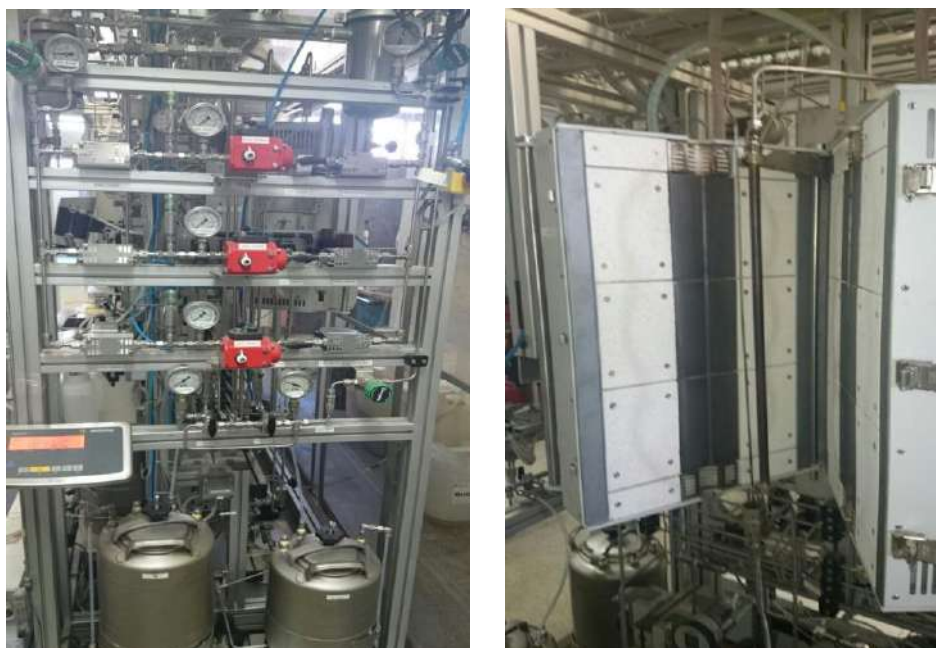
Figura 28 - Unidade 3R-HDT-20 - Vinci Technologies: (a) Seção de alimentação e (b) de reação.
