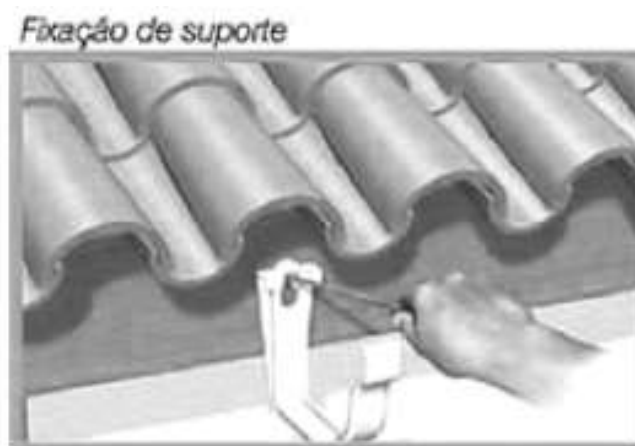
Figura 138 – Instalação da fixação de suporte para a calha.
