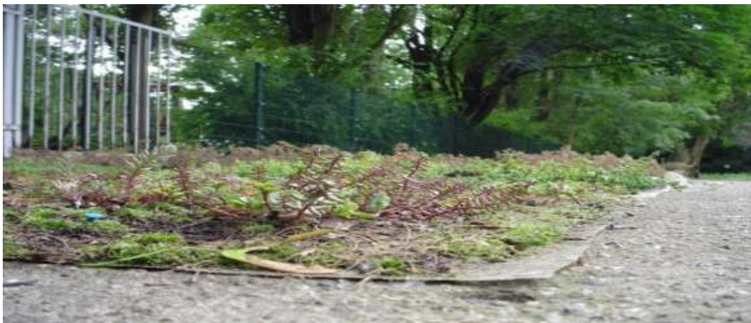
Figura 92 – Experimento de mantas com espessuras mínimas (5 cm) no IASP/HU – Berlin (FONTE: ROLA, 2008)
