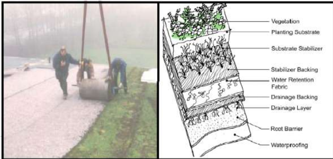
Figura 91 – Aplicação e seção transversal do sistema da manta vegetativa pré-cultivada Xero Flor System, oferecida pela Xero Flor Canada and Elevated Landscape Technologies (ELT).
