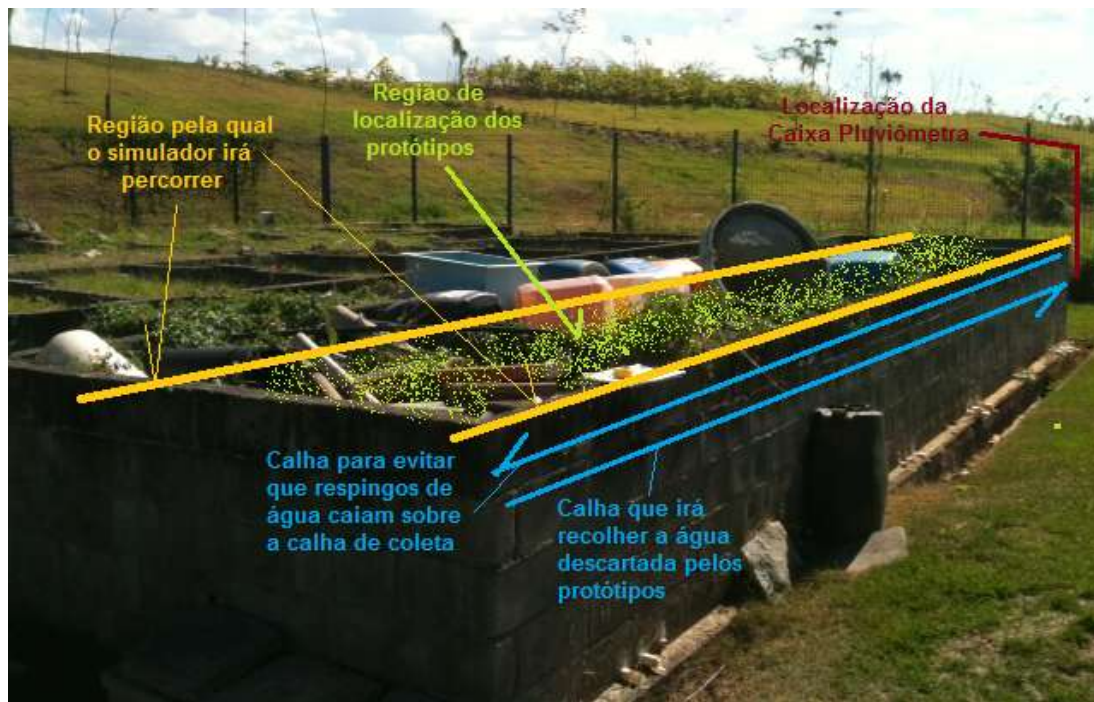
Figura 131 – Esquema do posicionamento da caixa pluviômetro, do simulador de água de chuva, das calhas e dos protótipos na bancada experimental do CESA/UFRJ.
