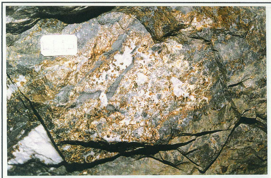
Foto 3 – 50.GE.BAS.5. Bolsão e vênulas de pirita e carbonato cortando o dolomito no contato com um nível dolarenito calcítico pouco brechado. Notar no centro da foto concentrações de cubos de pirita envolvidos por carbonato branco.
