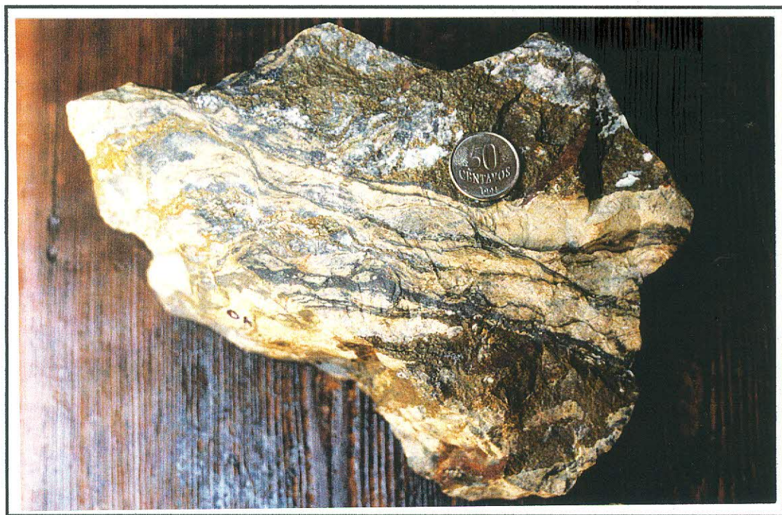
Foto 19 – Amostra 150.23JKA.26a. Duas bandas piritizadas nas partes externas, separadas por faixas de material amarelo claro rico em esfalerita com vênulas negras subconcordantes de galena.
