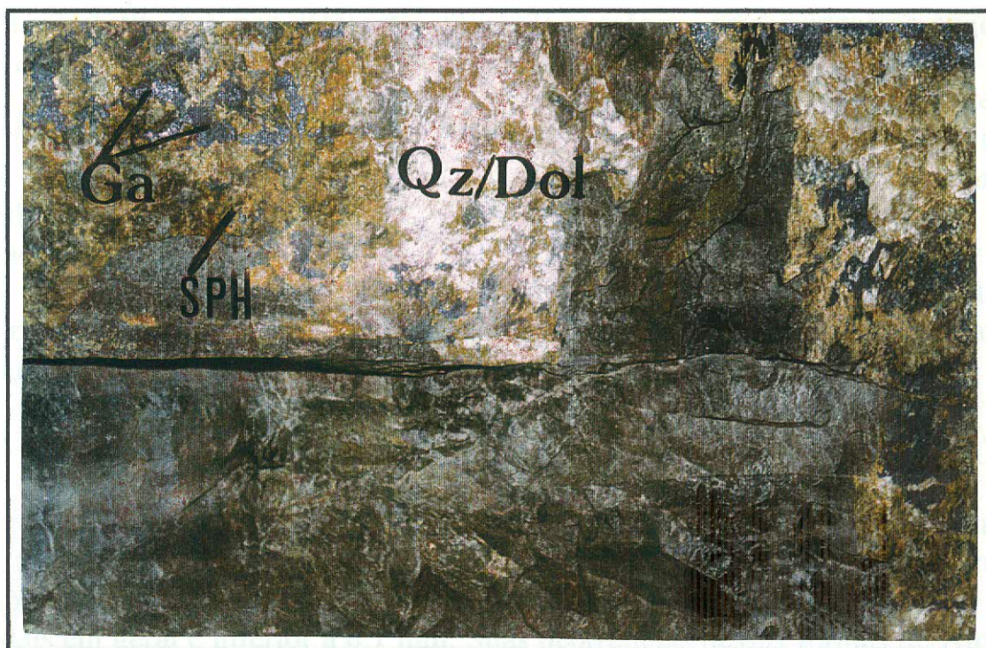
Foto 42 – 83.RA.M.32. A foto mostra vestígios do minério de veio na zona de contato com a encaixante. Atualmente este minério já foi totalmente lavrado. A porção branca no alto da foto tem aproximadamente 1 m de altura.
