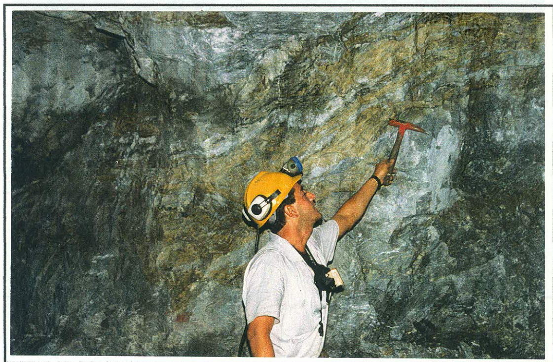
Foto 14 – 50-83.6N.12. Faixas de dolarenito calcítico fortemente mineralizado por esfalerita (cor amarela) interdigitado por níveis de dolomito cinza.
