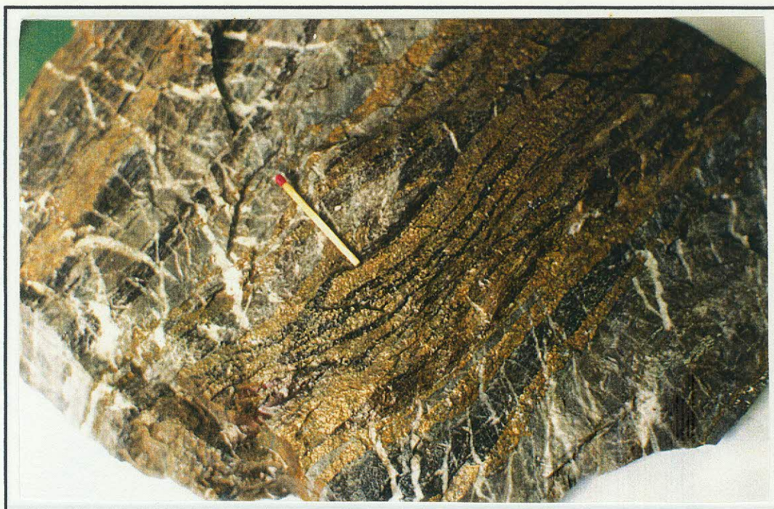
Foto 36 – Amostra 83.10N.16a. Rocha formada por bandas de chert, pirita e esfalerita. A galena é pouco observável nesta foto, ocorre em menor quantidade associada à esfalerita (canto superior esquerdo da foto). Todo conjunto é cortado por “tension gashes”, preenchidas por quartzo e dolomita.
