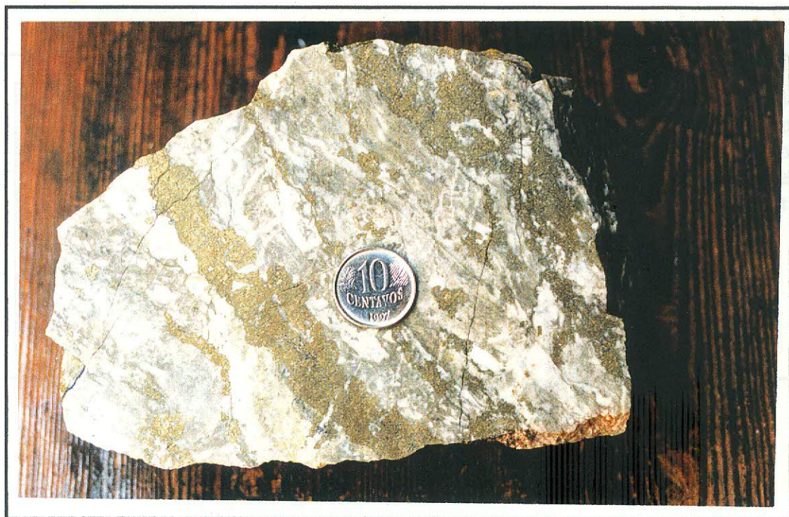
Foto 13 – Amostra 50-83.6N.12a. Alternância de bandas de pirita e de dolomito, cortadas por venulações de dolomita. Lentes de dolarenito calcítico mineralizado estão fracamente presentes.
