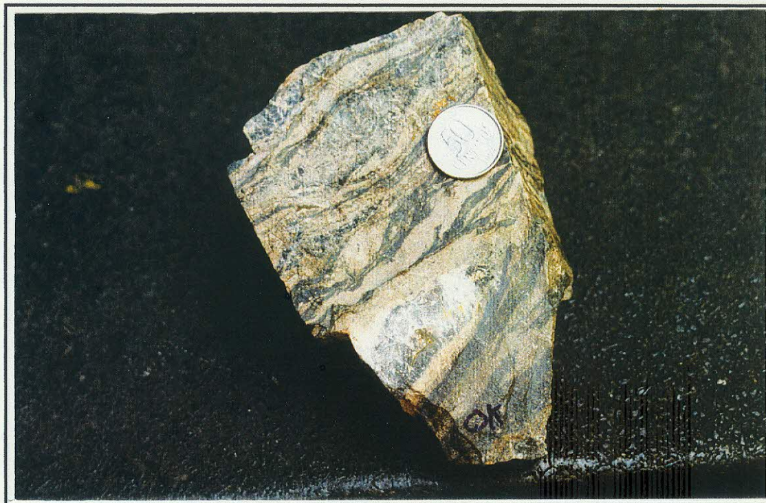
Foto 20 – Bandas de material amarelo claro rico em esfalerita com vênulas subconcordantes de galena.
