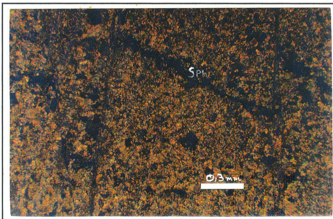
Foto 33 – Lâmina 183.GSW.L.8a. Foto tirada com luz transmitida, nicóis cruzados e objetiva 3.5/0.10 P. Zonas de cisalhamento com falhas de baixo ângulo deslocando a foliação Sx formada por esfalerita.
