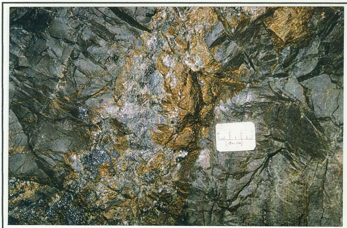
Foto 2 – 50.GE.BAS.5. Veio de pirita, galena e carbonato com fragmentos de dolomito. A pirita ocorre maciça em algumas partes do veio. Vênulas de pirita e galena formando a estrutura brechada no dolomito. Porções de dolarenito calcítico não brechado (canto direito inferior da foto).
