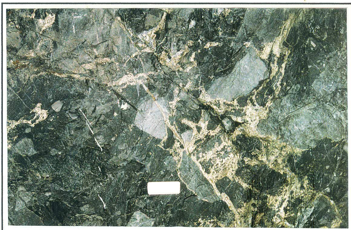
Foto 6 – 116.APM.21. Brecha constituída por intraclastos em tons de cinza médio e de vários tamanhos. Veios e vênulas de pirita + esfalerita cimentando os intraclastos e dissolvendo localmente o dolomito, formando estrutura brechada. Notar no centro da foto, um dos veios mencionados cortando um intraclasto. A tira branca tem aproximadamente 7,0 cm.
