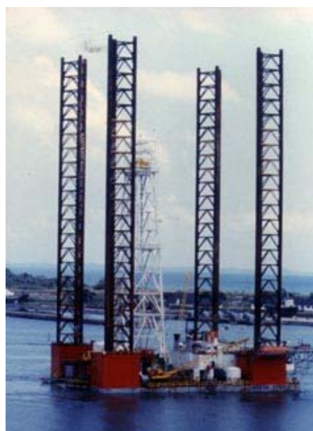
Figura 5 – Plataforma Auto-Elevatória North Star-I
