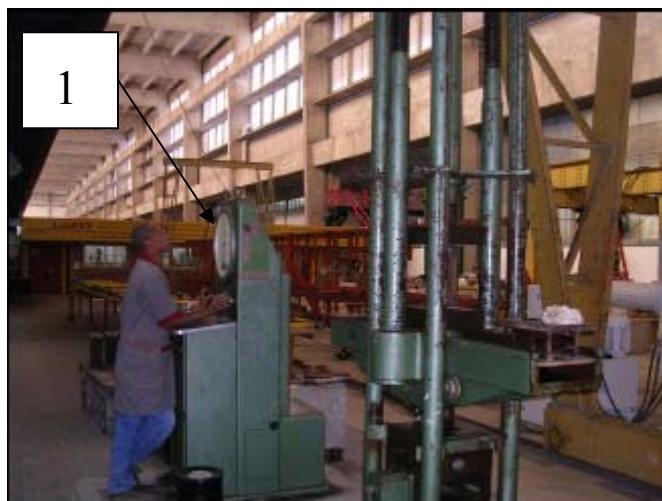
Foto 13 - Leitura da carga última: 1 - Leitura da carga última dos montantes no dinamômetro.
