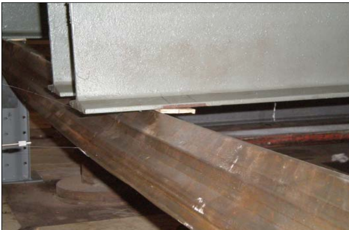
Foto 4 - Longarina sofre torção durante o ensaio.
