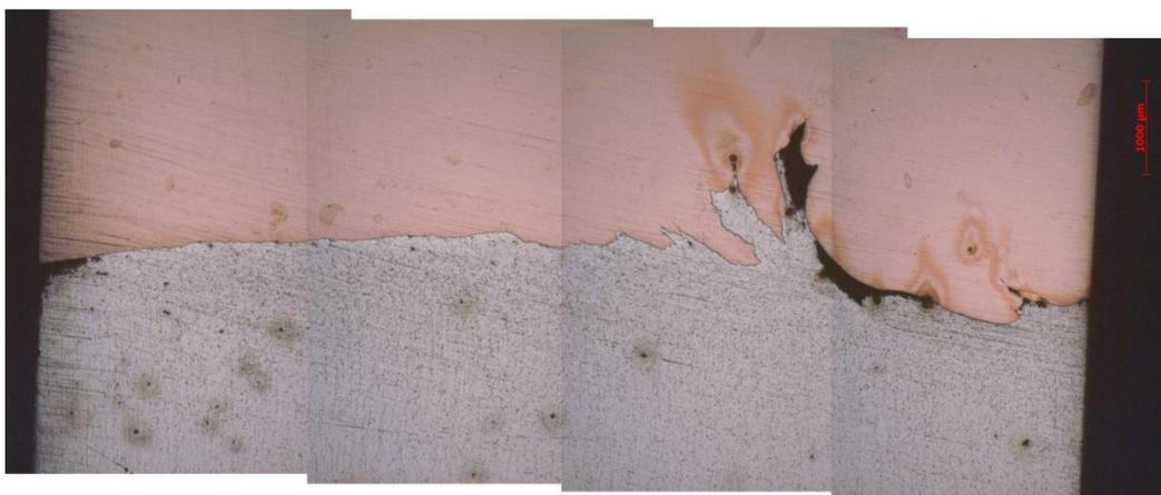
Figura 4.10: Ferramenta sobre Cu, superfície de apoio.
