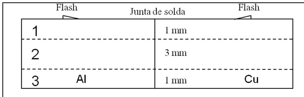
Figura 3.3: Esquema de medida do deslocamento de matéria e Flash.
