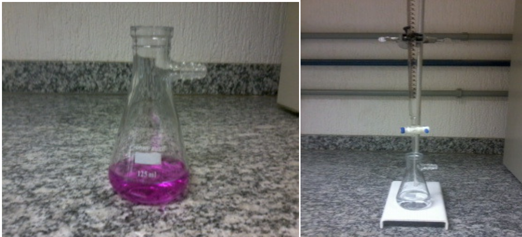
Figura 4. Titulação do KOH retirado do ensaio de biodegradação
