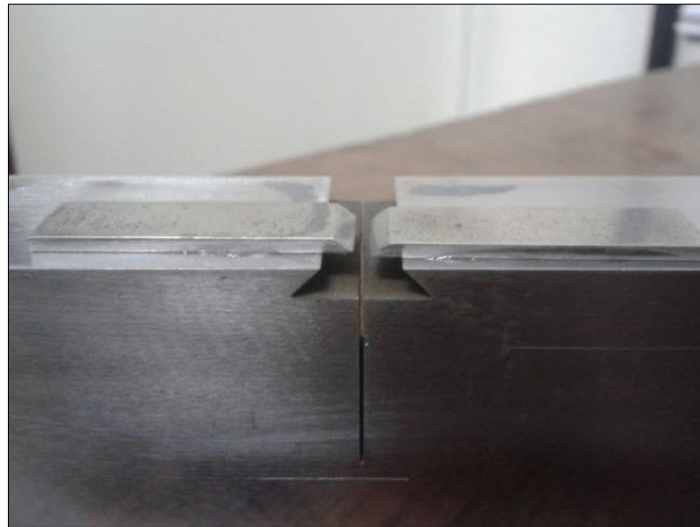
Figura 22 – Foto do corpo de prova com as facas coladas.
