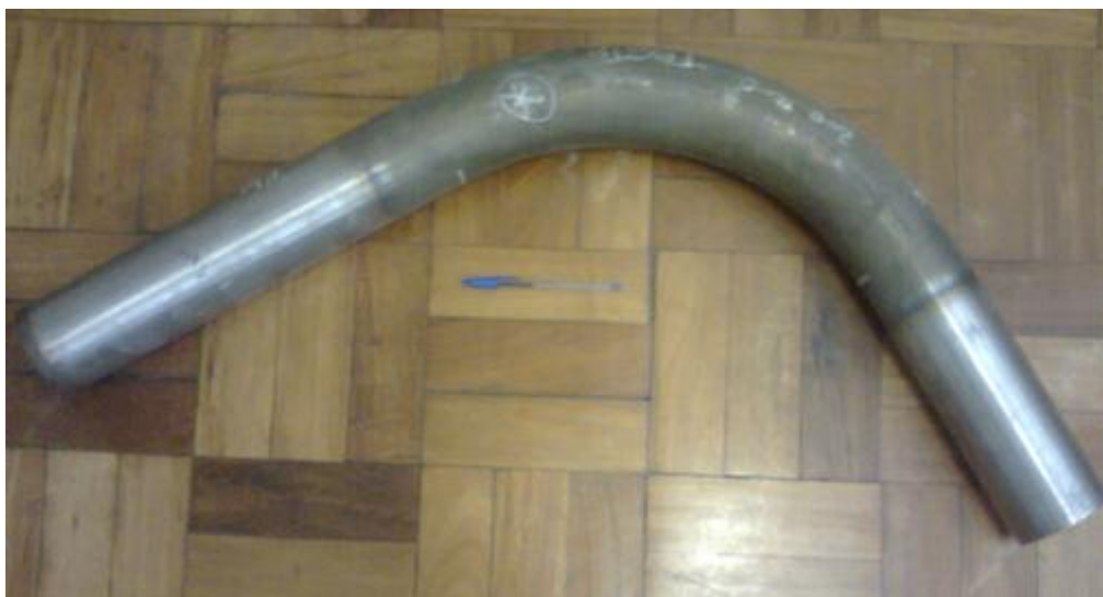
Figura 32. Peça de aço inoxidável duplex UNS S31803 curvada.
