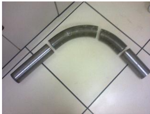
Figura 33. Tubo de AID UNS S31803 cortado em partes.
