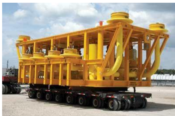
Figura 13. Manifold oceânico. (OFFSHORE, 2011)
