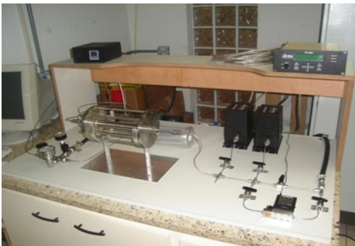
Figura 5.3 – Equipamento utilizado para realização dos testes de permeação por hidrogênio via gasosa.
