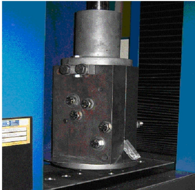
Figura 3.2.2.3: Fotografia da matriz de EAC utilizada montada na máquina geral de ensaios.
