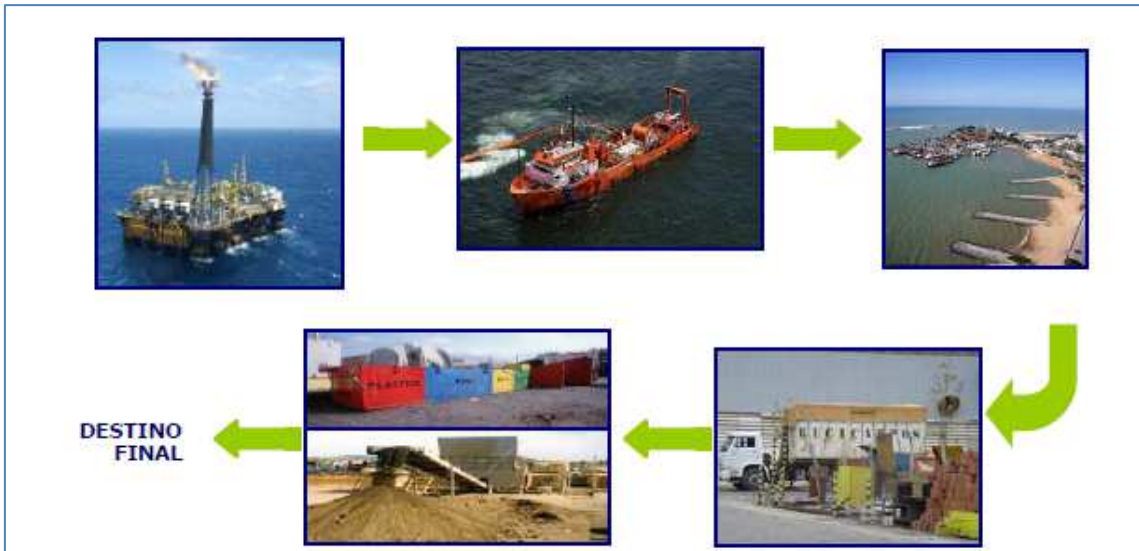
Figura 29: Fluxograma referente à movimentação dos resíduos gerados em unidades marítimas de produção de petróleo até a disposição final.
