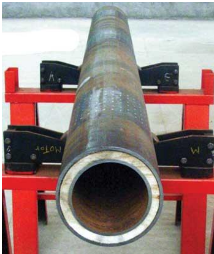
Figura 3.1 Um exemplar de duto sanduíche utilizado nos modelos de baixa escala[16].
