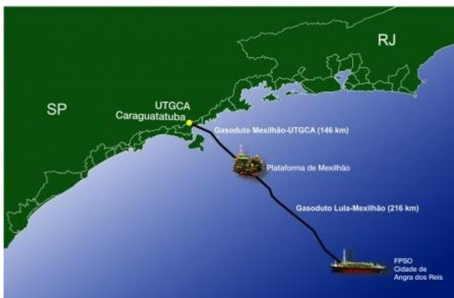
Figura 4.1 Esquema ilustrativo do gasoduto Lula-Mexilhão [29].
