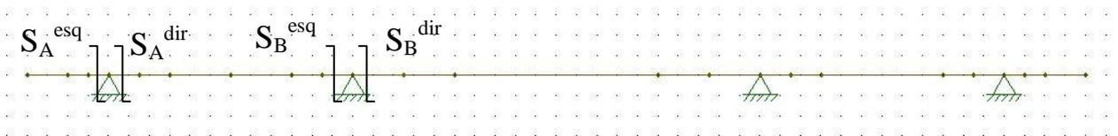
Figura 51. Seções analisadas para cortante.
