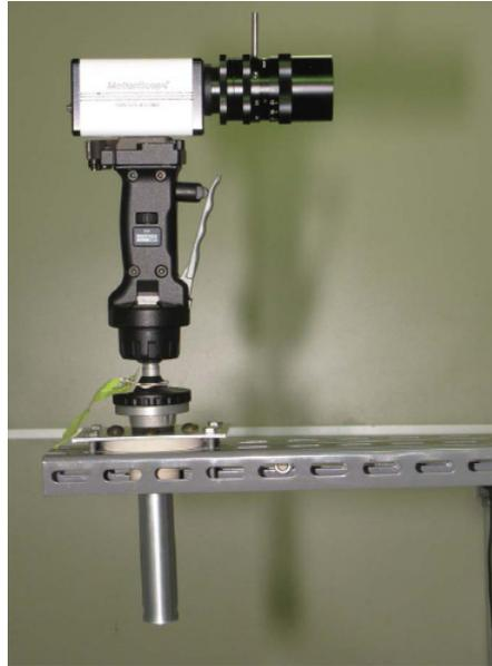
Figura 3.5: Câmera digital fixa na ponta do suporte.
