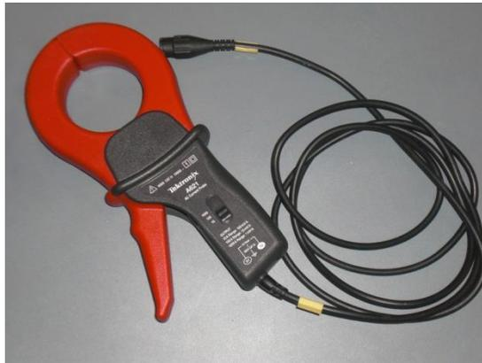
**Figura A.2.2: Alicate amperímetro (Tektronix)**
