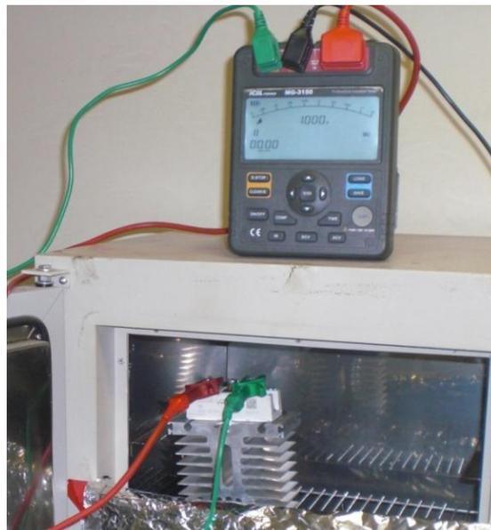
**Figura 2.16: Montagem para medição da resistência interna do tiristor**
