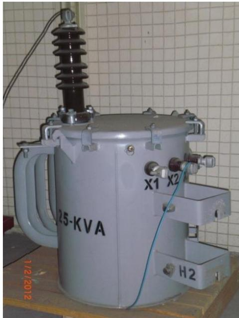
**Figura A.1.8: Transformador monofásico da ITB**
