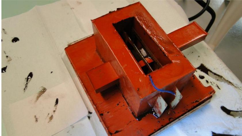
**Figura 2.21: Forma de borracha para fabricação do transformador planar.**
