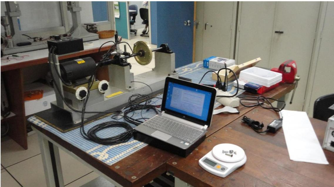
Figura 3.1: Rotorkit: Sistema de simulação de máquinas rotativas.
