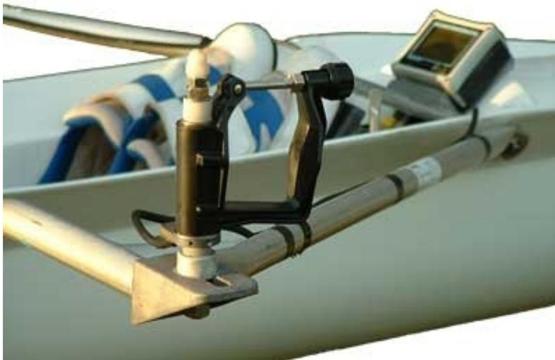
**Figura 8 - a) Forqueta modificada do Power Line Instrumentation. b) Power Line Instrumentation instalado no barco. Fonte: Peach Innovations [9]**
